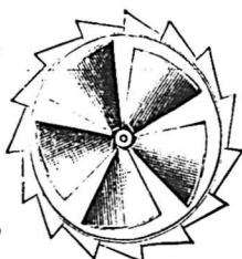
L'une des principales propriétés de ce ventilateur c'est qu'il est mis en mouvement, non seulement par le mouvement vent, mais aussi par la différence de température de l'intérieur et de l'extérieur de la cage. L'hélice placée à l'intérieur de ce ventilateur non seulement établit un courant d'air continu, mais aspire ou pompe toutes les poussières, la fumée, les vapeurs, l'air vicié, etc.
