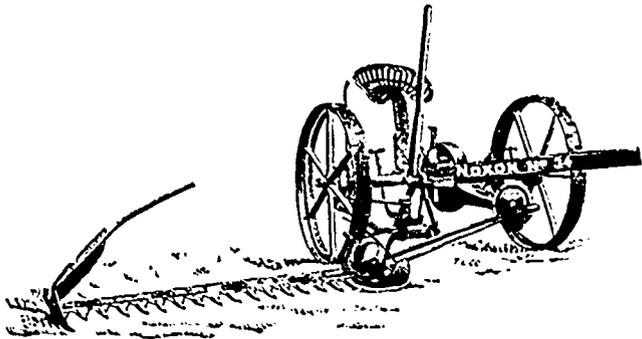
Le patron le plus moderne et la construction la plus nouvelle de faucheuse avec faux en avant, parfaitement flottante; la barre tranchante étant contrebalancée par le poids du conducteur. En touchant un ressort du pied, la barre tranchante se lève instantanément, ce qui lui permet de passer par dessus toutes obstructions et de tourner les coins. Légère de tirage, la plus rapide et celle qui coupe la mieux. Agents dans toute la Province de Québec.
