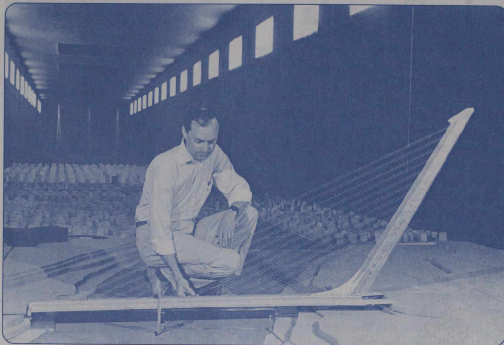
Peter King, professeur d'ingénierie à l'université de «Western Ontario», observe une réduction authentique du pont Alamillo dans un environnement de soufflerie.
