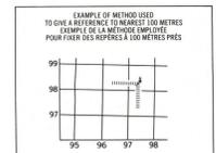
REFERENCE POINT POINT DE RÉFÉRENCE: CHURCH - ÉGLISE (see above) (voir ci-dessus). EASTING: Read number on grid line immediately to left of point. LONGITUDE: Lire le chiffre de la ligne de quadrillage immédiatement à gauche du point. Estimate north-south of a square from this line eastward to point. Estimer le nombre de diamètres du carré entre cette ligne et le repère en direction est.
