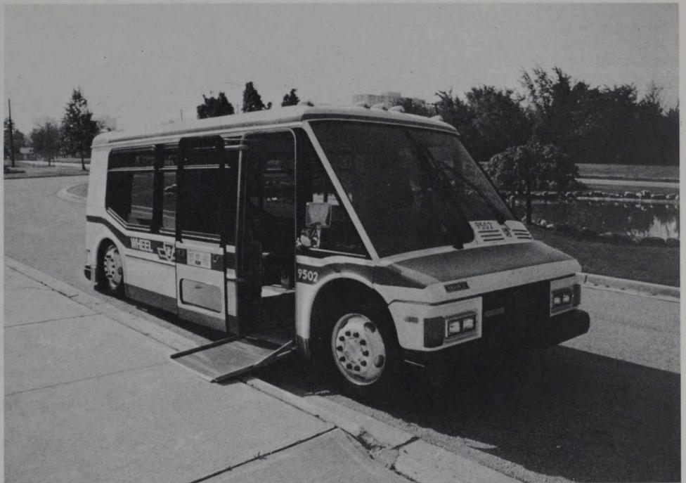
L'Ontario Bus è stato appositamente disegnato per il trasporto delle carrozzelle
