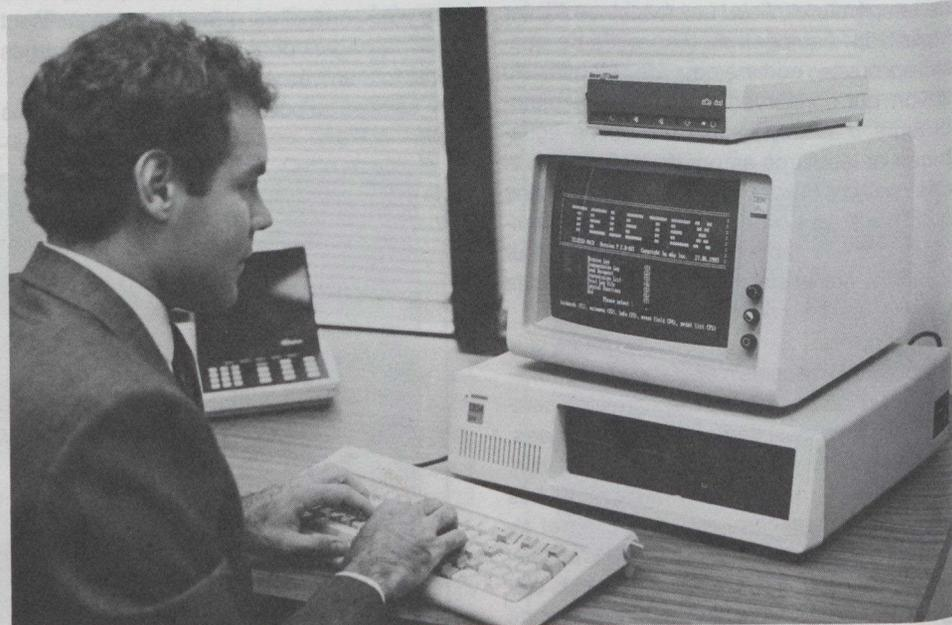
Le contrôleur universel Télétex (CUT) que l'on voit ici au-dessus d'un ordinateur personnel, permet aux usagers de cet appareil et de machines de traitement de texte d'échanger des documents imprimés sur du papier à lettres, en quelques secondes seulement, d'un bout à l'autre du pays ou du monde, par l'intermédiaire du service Télétex de Telecom Canada.
