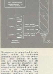
automatically sampled and analysed by gas chromatography. Amount of ethylene formed from acetylene indicates activity of nitrogenase. Dans des cultures microbiennes, la nitrogenèse s'évalue en mesurant continuellement la réduction des traces d'acétylène injectées dans l'air circulant dans les cuves. Les effluves sont échantillonnées automatiquement et analysées par chromatographie en phase gazeuse. La quantité d'acétylène transformée en éthylène permet d'évaluer l'intensité de la nitrogenèse.
