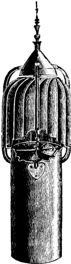
Il est mis en mouvement, non seulement par le moindre vent, mais aussi par la différence de température de l'intérieur et de l'extérieur de la bâtisse. L'hélice placée à l'intérieur de ce ventilateur établit un courant d'air continu et aspire toutes les poussières, la fumée, les vapeurs, l'air vicié, etc.
