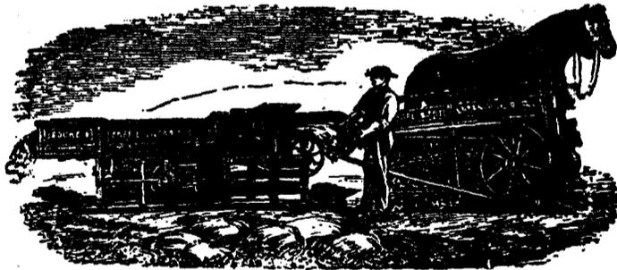
La machine à battre représentée dans la gravure plus haut est notre moulin Vibrateur. Cette machine a un silon de 28 pouces de long, les dents sont en acier garanti pour plier à froid sans se casser, tel que le norway.
