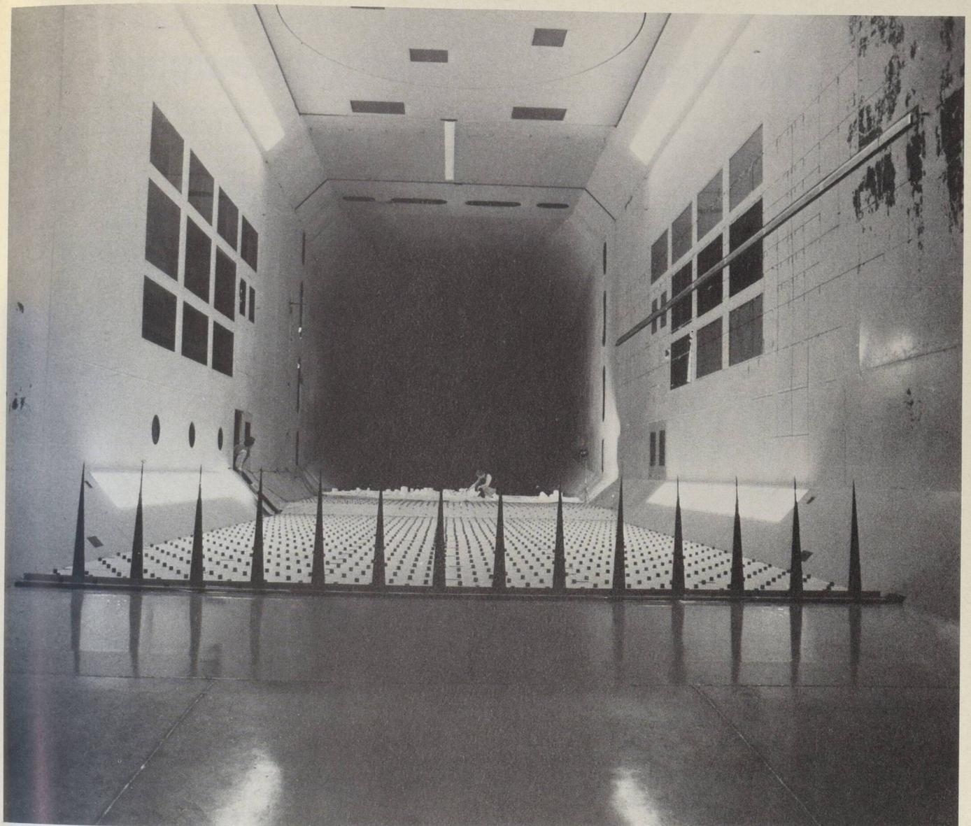
Vue prise dans la soufflerie de 9 m x 9 m de l'ÉAN, dans la direction du vent. Ces pointes et les rangées de plaques rectangulaires permettent de simuler la turbulence du vent telle que ressentie naturellement dans les grands espaces découverts et forcent le vent à décroître sa vitesse lorsqu'il s'approche du sol. La maquette de la ville est placée immédiatement après ces rangées de plaques. (Photo: Bruce Kane, CNRC)
