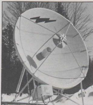
d'autres stations canadiennes et retransmis par l'un des satellites géostationnaires Anik. Elle peut également émettre ses propres signaux. Ce terminal d'un très faible encombrement ne demande que quelques heures de montage. Il offre pourtant toute la gamme des com-
