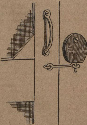
Il se compose uniquement d'un crochet bien ordinaire au-dessus duquel est suspendue par une vis une petite planchette en bois ayant  $\frac{1}{2}$  pouce d'épaisseur, 2 de hauteur et 1 de largeur.
